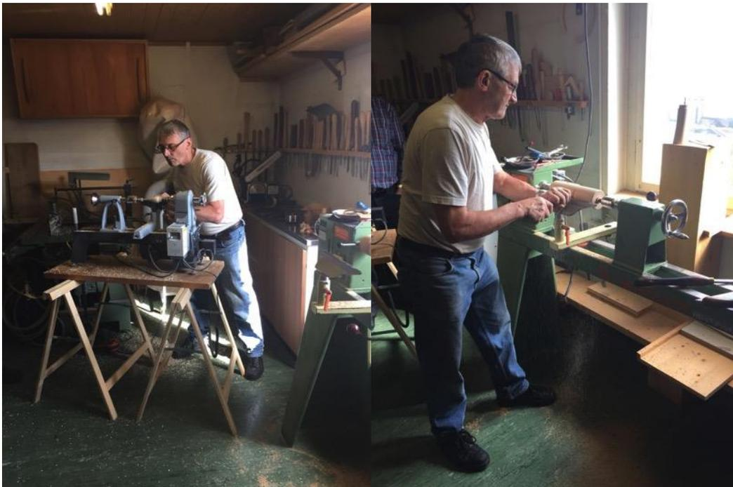
Für Pfeffermühlen aus mehreren Holzarten werden zuerst die verschiedenen Holz-teile in unterschiedlichen Formen verleimt und durch das anschliessende Drechseln entstehen dann verschiedenfarbige Holzmuster. Die fertig gedrechselten Holzteile werden eingefettet oder eingeölt und stehen dann für den langjährigen Gebrauch zur Verfügung.
